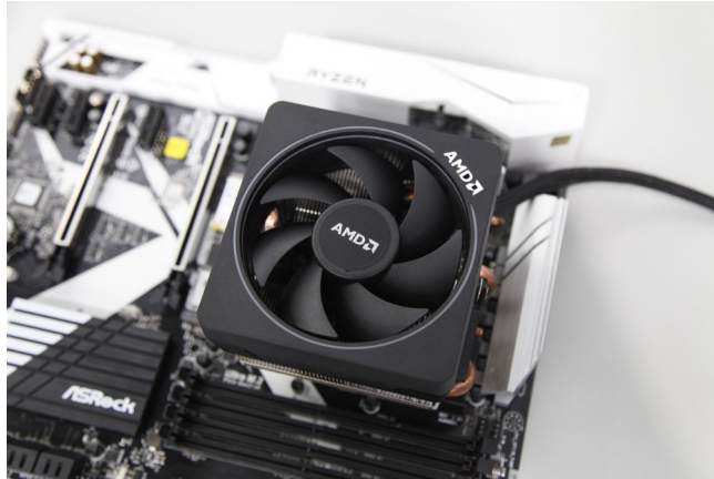
Foto a sinistra: un processore installato sulla scheda madre; a destra, la ventola montata sul processore.
